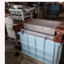
▲ 電解処理装置
